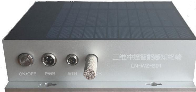
电力物资配送车载终端 LN-WZ-S01（三维冲撞智能感知终端）作为无线网络终端，负责采集运输物品的振动、温湿度和视频数据，通过 4G 无线网络上传到公网网络中，通过公网 IP 地址链接自己服务器的平台系统，完成数据上传功能。硬件电路集成 6 轴运动传感器、温湿度传感器、4G 无线通信模块、定位模块、本地存储模块等，嵌入式软件在硬件支持下，实现传感器数据采集、图像数据采集、无线通信、定位等功能。
